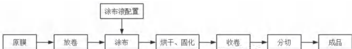
图 2.5-1 项目生产线生产工艺流程图
